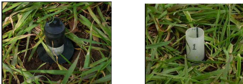
Figure 5.6: Tubul de măsurare a umidității din sol instalat în Site 1
